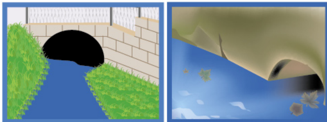
Figura 3. Puentes y alcantarillados estrechos a lo largo de quebradas en la ciudad: si la cantidad de agua es excesiva o si hay taponamiento por acumulaciones de basura, se convierten en puntos de desbordamiento del río.
