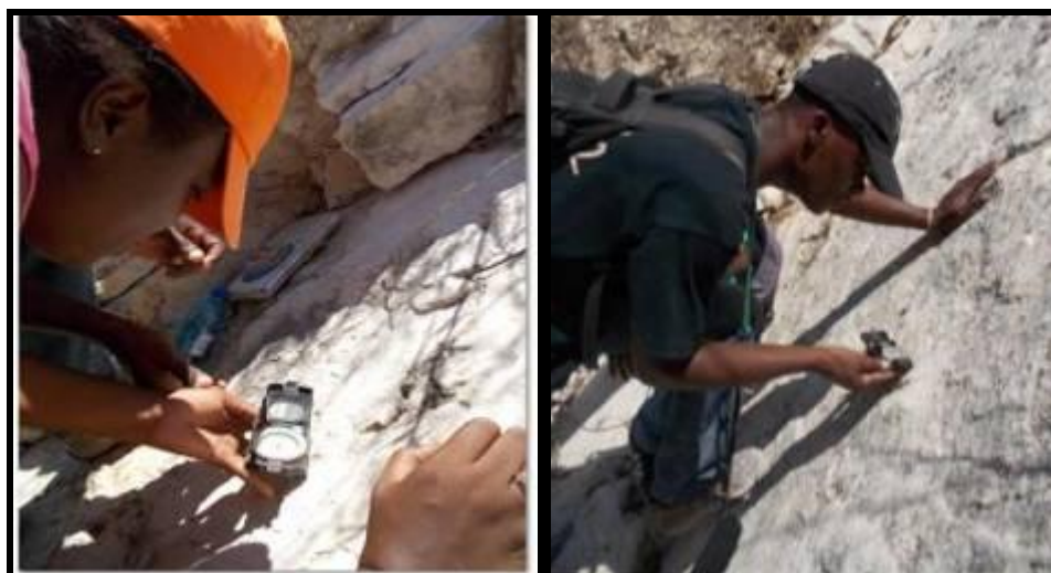
FIG. 13: Formation des stagiaires géologues du BME et de l'ENGA pendant l'étude de terrain (mesure de la géométrie et position spatiale des couches géologiques, des failles* et plis*).
