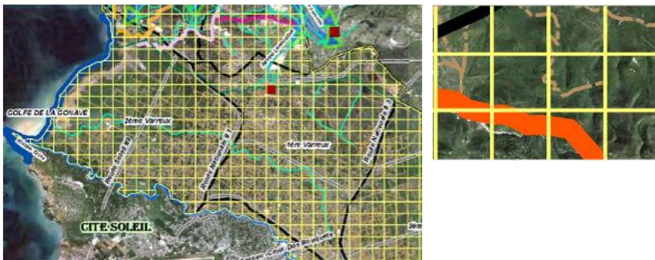
FIG42: Grille de 500 m * 500 m pour l'étude de photo-interprétation (à gauche) et détails de la grille de 500 m * 500 m (à droite).
