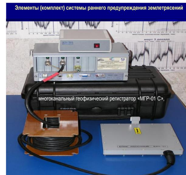
Рис.7. Многоканальный геофизический регистратор для дооснащения сейсмостанций в целях раннего предупреждения землетрясений (г. Томск, РФ)
