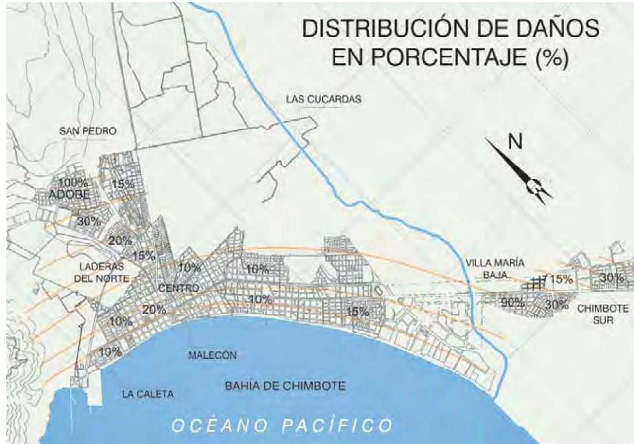
>>F-3.1.b Distribución de daños en las viviendas de albañilería de la ciudad de Chimbote, tras el terremoto de 1970. En la localidad de San Pedro, los daños en las viviendas de adobe llegaron al 100%.
