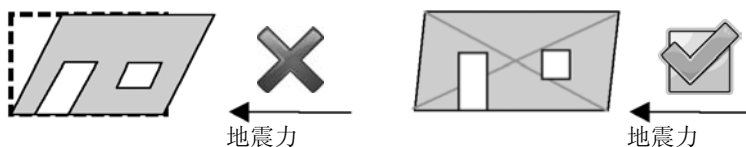
横向刚性不足造成侧墙变形
